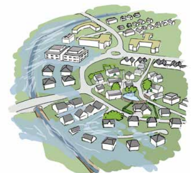
Der gerade Fluss ohne Auen bei Hochwasser
